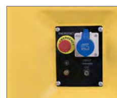
Caixa de comando com tomada de corrente de 230 volts
