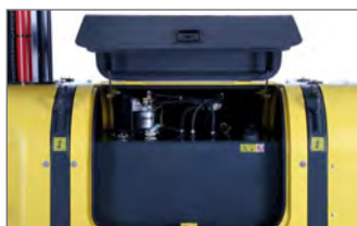
Capot de acesso e componentes em carbono para reduzir o peso.
