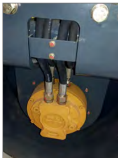
Ponto de lubrificação em cada rolo com Motor Poclairin.
