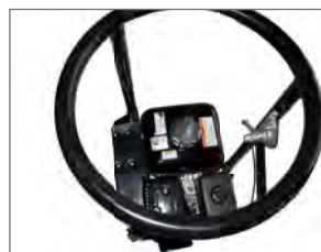
Acelerador colocado no centro do volante
