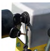
Caixa de arranque eléctrico integrada no punho
