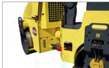
Articulação dupla com pontos de lubrificação de patente 'Pac-pivot'
