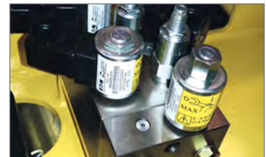
Sistema hidráulico em linha que melhora a segurança e o funcionamento
